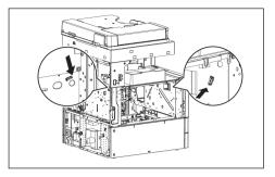
9 在机器上安装好Wifi模块后,如图所示, 用线夹将其固定。
