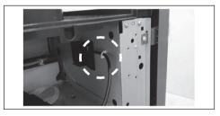
10 如图所示,使电线从机器后面的孔里出来。
