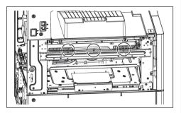
**12** 使用机器后面的线夹将电线收齐整理后 连接到机器主板上。
