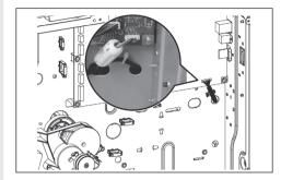
13 安装机器的左侧外壳(螺丝6个)。
