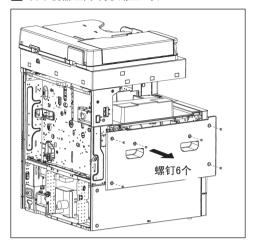
6 拆下机器内部的框架(螺丝4个)。
