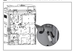
11 用第<sup>6</sup> 步中取下的框架上的线夹将Wifi 模块的电线收齐后在机器上安装。
