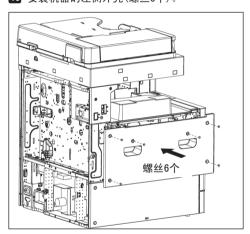
14 安装机器的后侧外壳。(螺丝14个)
