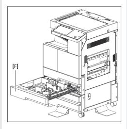
8 请将A3 Paper Feed Unit通过 2个螺丝[E]进行 固定。
