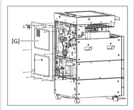
11 如图所示请将电线[II] 与复合机的Connector 进行连接,然后将线夹(I) 设置在本体Frame 上,对[II] 进行固定。
