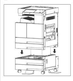
7 请将复合机的2段 Tray[F]拆除。(Tray 拆除时 请将Side Fence调整至 A5用纸的位置后再进行 拆除)
