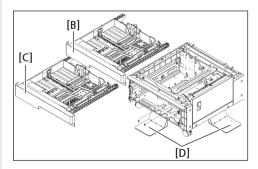
4 A3 Paper Feed Unit의 저판에 Safety Part를 Bolt [E](부품1) 4개로 고정해 주십시오.(Bolt 조립시 hole을 볼 수 있게 Safety Part 위치 조정함)
