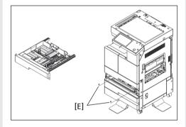
⑤ 请将复合机的2段Tray重新设置好。 (Tray 设置时请将Side Fence调整至A5用纸的 位置再进行设置) 10 请将复合机后盖[G](14个螺丝)拆除。
