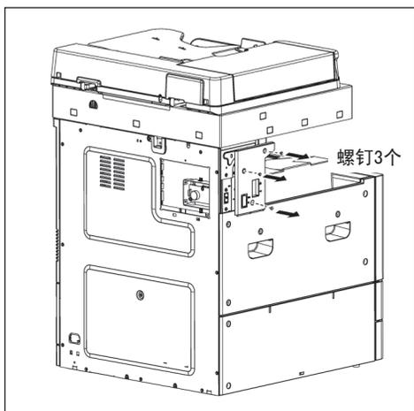
**8** 安装本机的左侧盖板(螺钉3个)。
